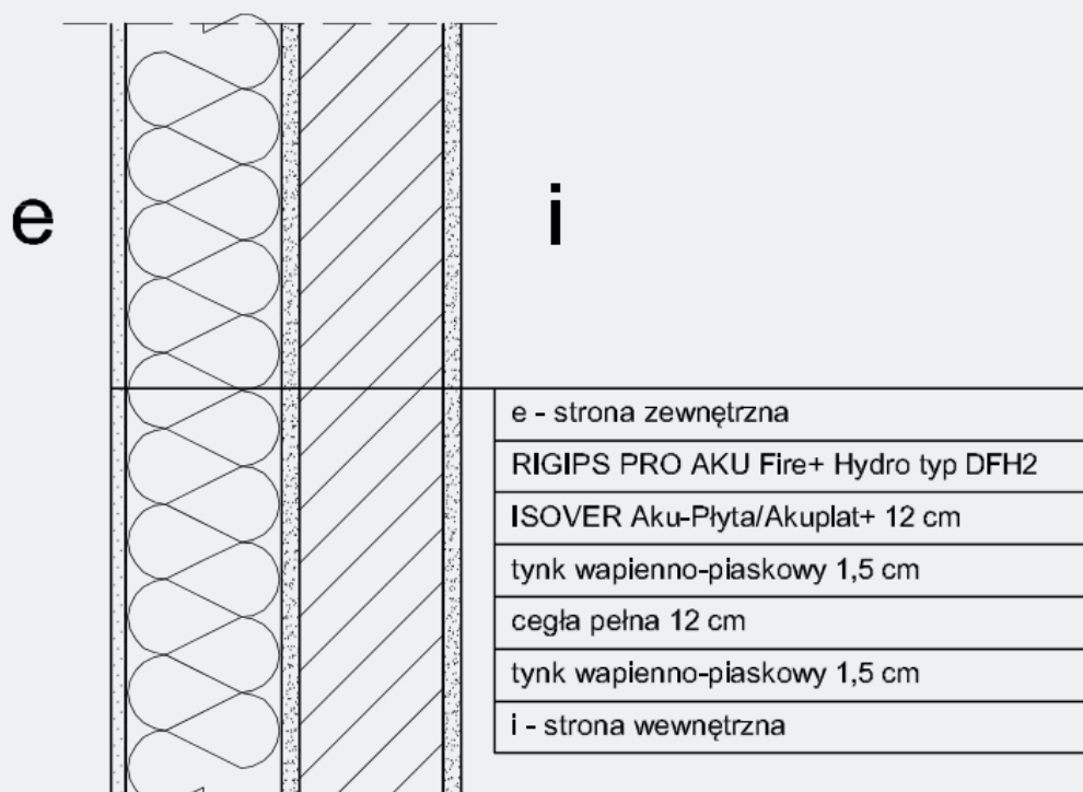
il. 48. Układ warstw materiałowych dla ściany wewnętrznej oddzielającej mieszkanie na poddaszu od nieogrzewanych strychów w stanie projektowanym.
