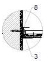
Połączenie ze ścianą
